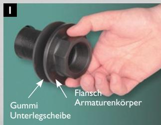
1. Entfernen Sie die **Gegenmutter** und die **LDP Unterlegscheibe** (die härtere der 2 Scheiben) aus dem **Tankarmaturenkörper**. Schieben Sie den **Tankarmaturenkörper** durch das Loch in den Tank. Die **Gummichtung** muss immer zwischen dem **Armaturenkörper** und der Tankwand sein (Stellen Sie sicher, dass die Rippen auf der **Gummischeibe** dichten - bezogen auf die Tankwand).
