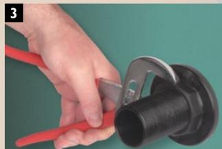
3. Ziehen Sie die **Gegenmutter** fest, so dass die Vorderseiten beider Unterlegscheiben Kontakt mit der Tankwand haben, damit es wasserdicht ist. Stellen Sie sicher, dass alles den Angaben des Tankherstellers entspricht. Nicht zu fest anziehen.
