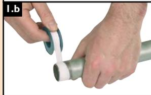
1.b Use un sellador de cinta de teflón. El sellador adecuado para juntas roscadas no se endurece, es compatible con el plástico y no genera superficies resbaladizas que permiten el exceso de torque.
